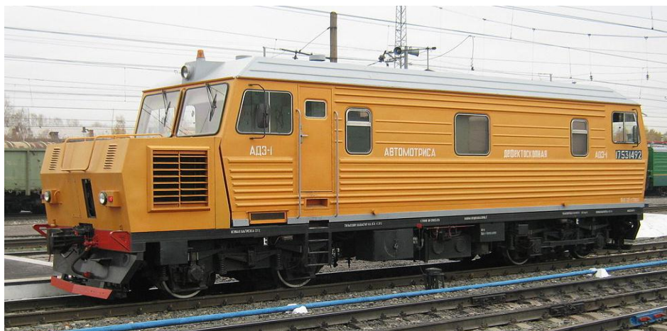
Рисунок 1.1 – Автомотриса дефектоскопная электрическая. Калужский завод путевых машин и гидроприводов
