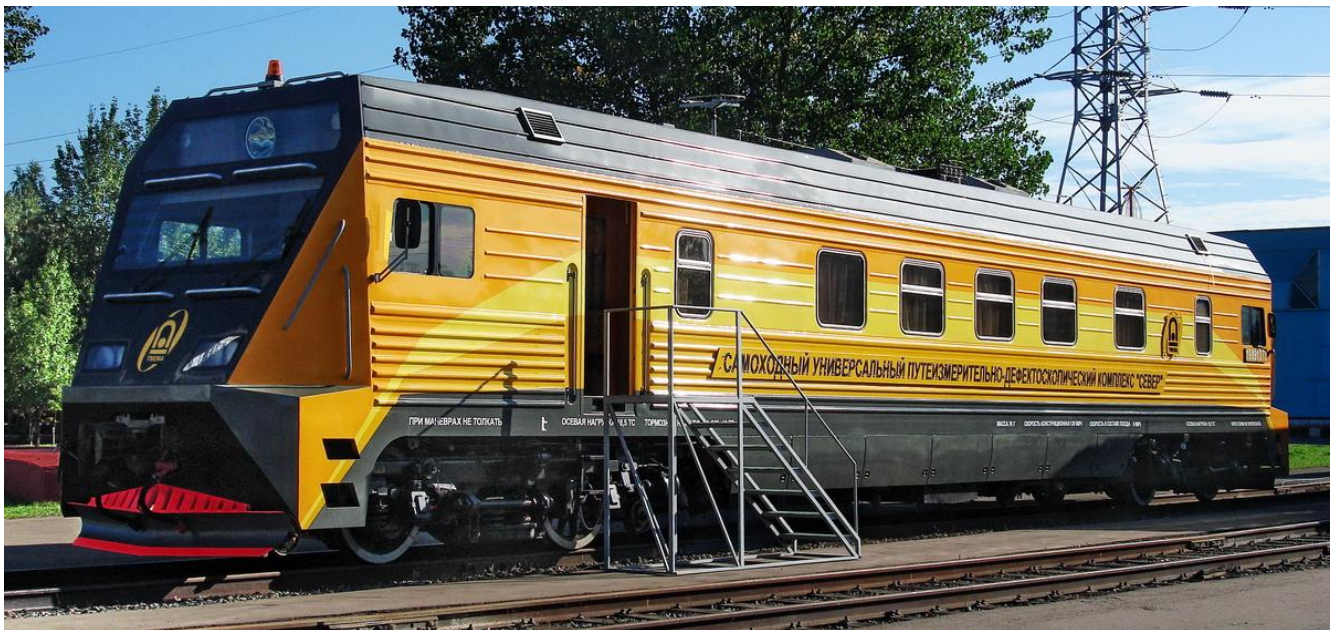
Рисунок 2.1 – Самоходный универсальный путеизмерительно - дефектоскопический комплекс – автомотриса «Север» производства ЗАО «Фирма ТВЕМА»
