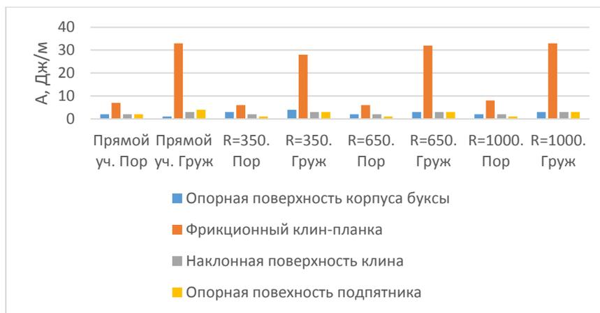
**Рисунок 6.3 - Распределение значения удельной работы сил трения по типам участков**
