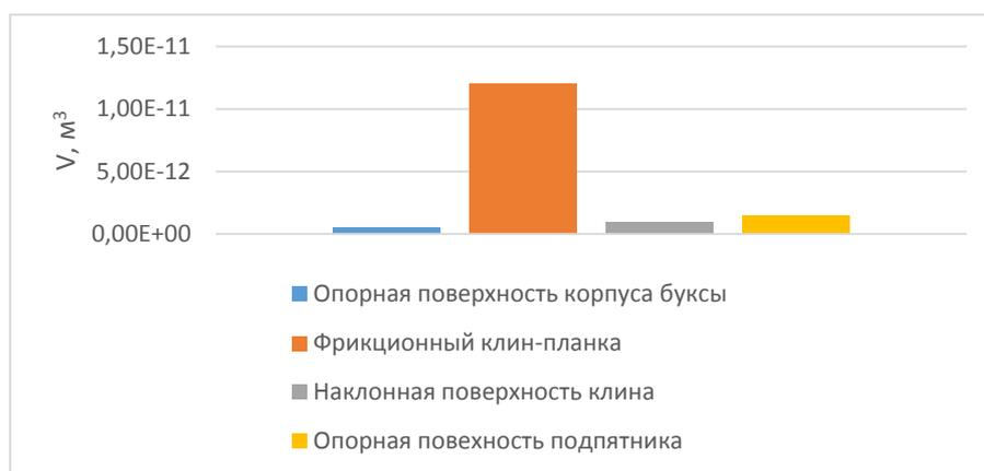
**Рисунок 6.5 - Диаграмма распределения объемного износа на 1 м пути**
