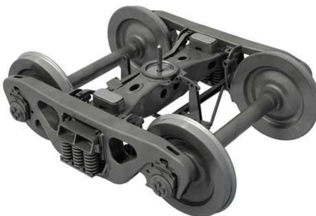
**Рисунок 2.10– тележка 18-9810 с осевой нагрузкой 23,5 т/ось**
