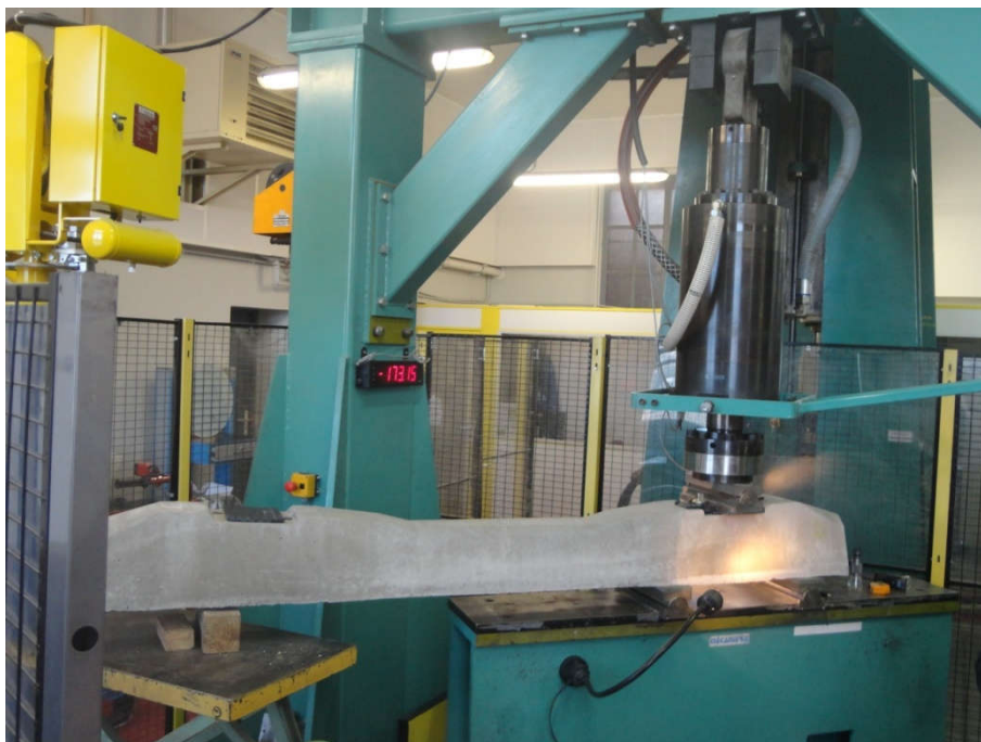
Рисунок 2.4 – Организация рабочего места при проведении лабораторных испытаний железобетонной шпалы
