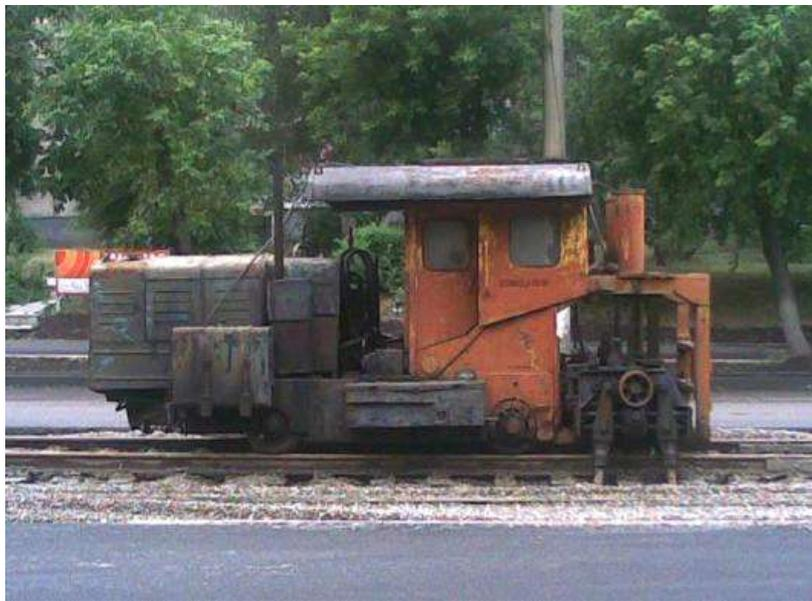
Рисунок 1.1 - Шпалоподбивочная машина ШПМ-02
