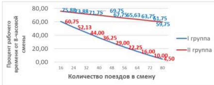
Рисунок 4.1 - Процент рабочего времени от общего табельного времени при 8-часовой смене в зависимости от количества поездов в смену для работ текущего содержания железнодорожного пути I и II группы [22]
