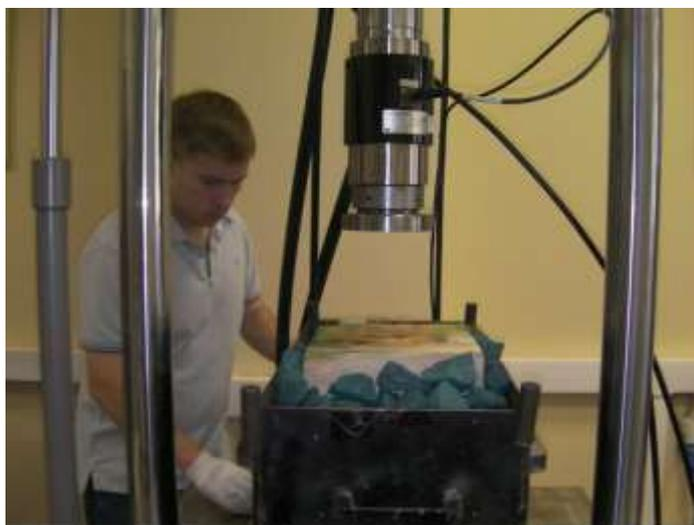
Рисунок 2.6 - Испытания образца модели шпалы, выправленной пневматическим суфляжем на испытательной машине
