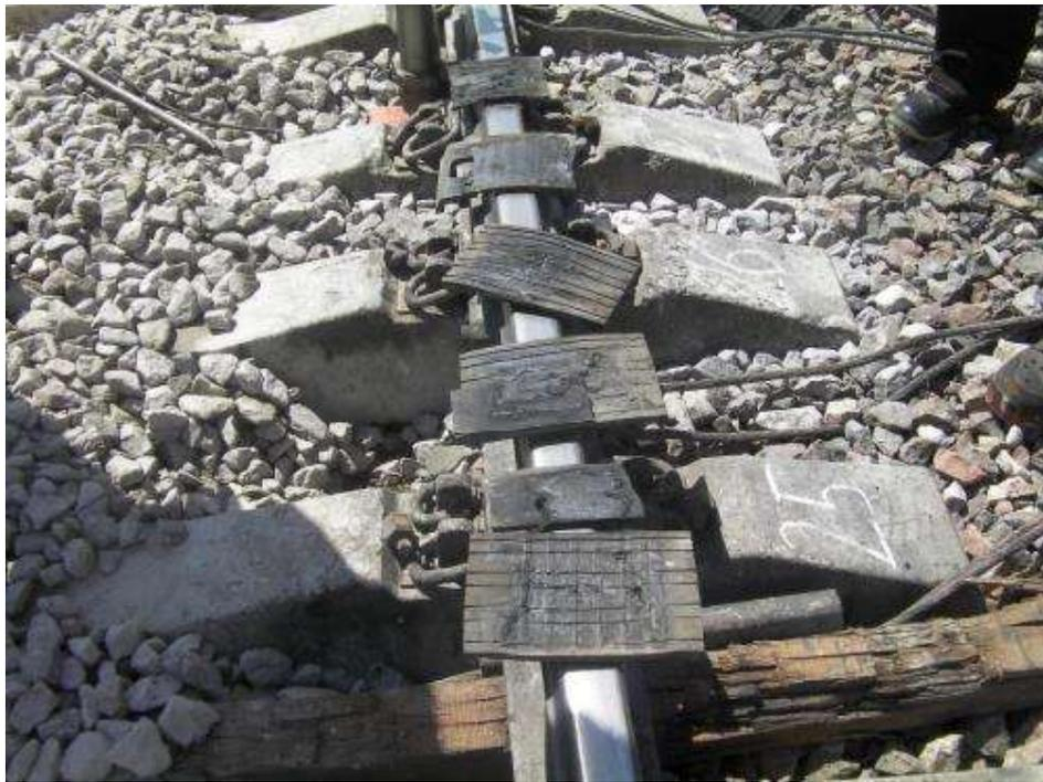
Рисунок 3.2 - Деформированные подрельсовые прокладки
