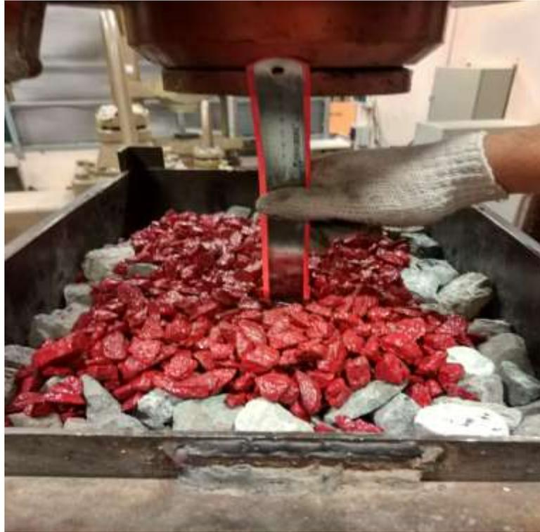
Рисунок 2.13 - Отсыпка слоя фракции 10-20 мм поверх щебня путевой фракции
