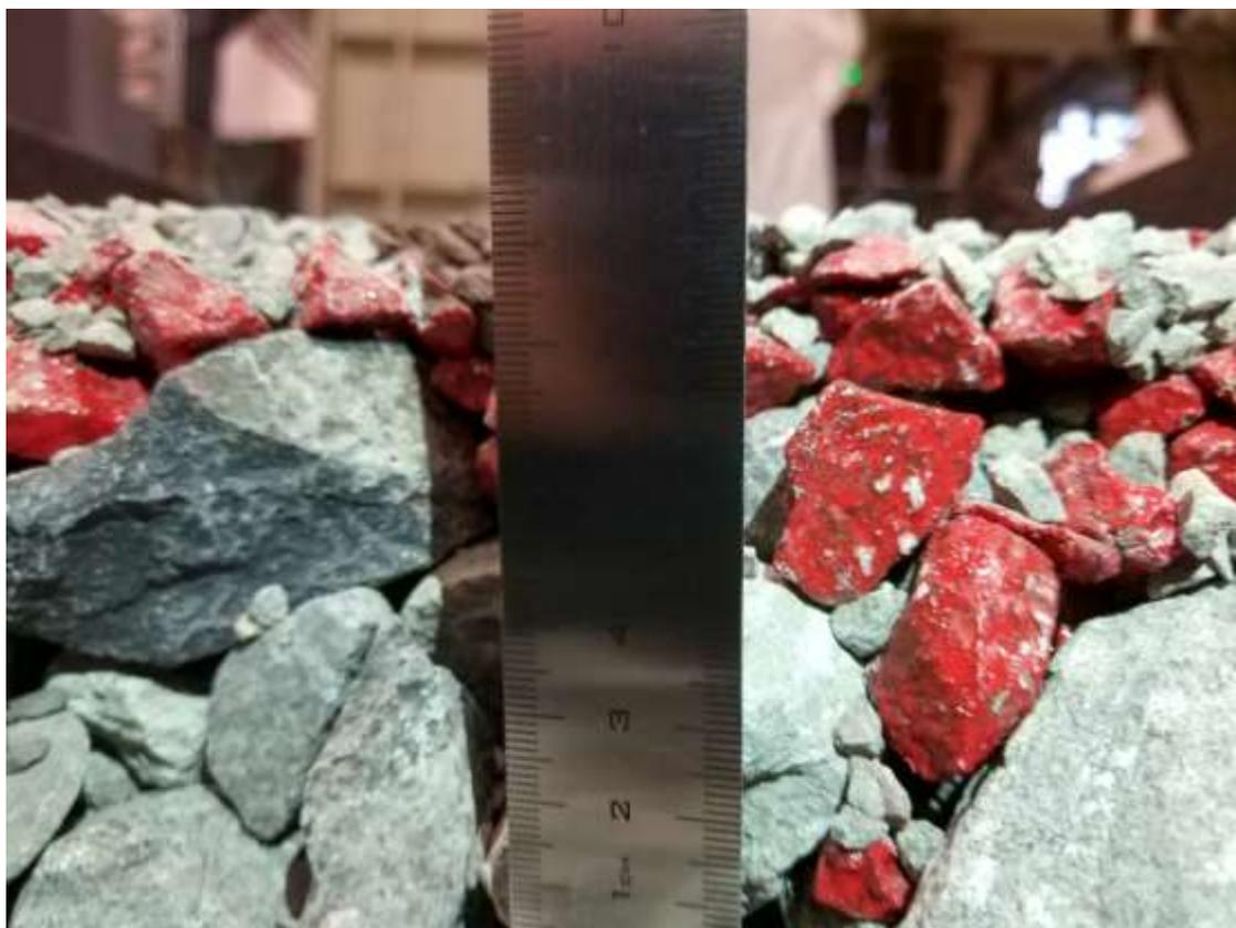
Рисунок 2.17 - Взаимная миграция щебня путевой фракции, щебня фракции 10-20 мм и щебня фракции 5-10 мм на частично разобранной модели
