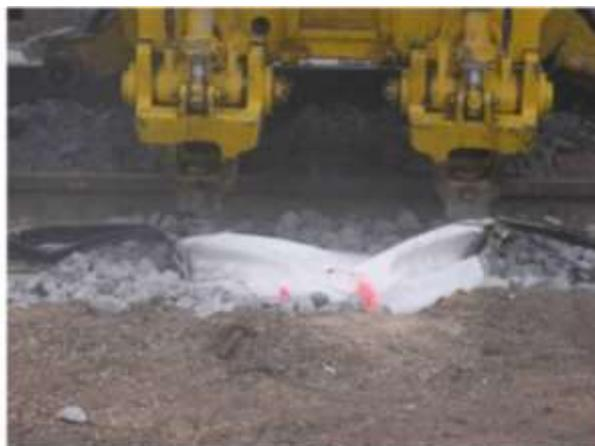
б - Полевые испытания подбивки (балластный мешок); рисунок воспроизведен из [68]
