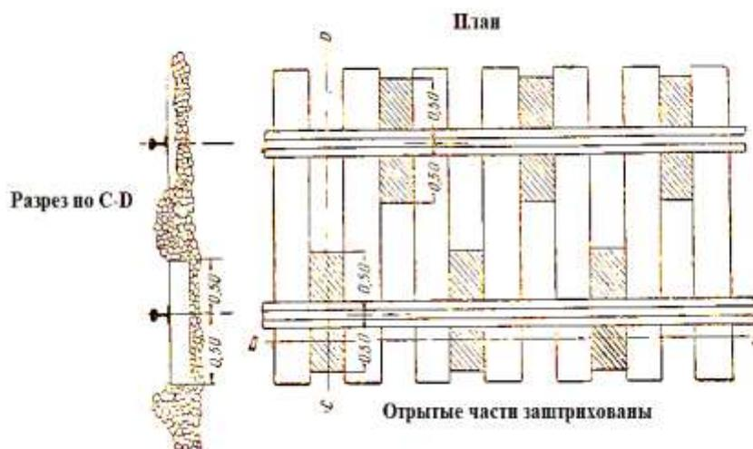
Рисунок 1.3 - Порядок отрывки шпальных ящиков
