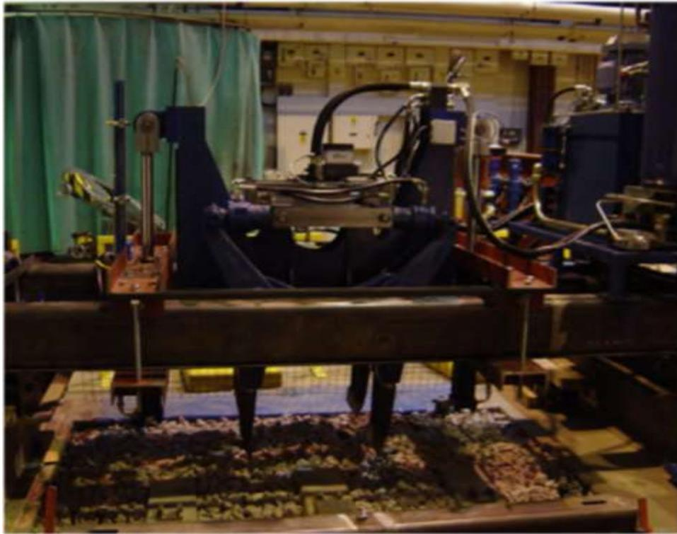
в - Лабораторные испытания подбивки (модель пути); рисунок воспроизведен из [68]
