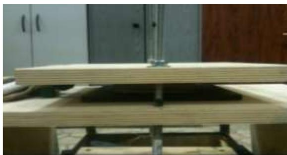
Рисунок 2.3 - Приспособление для вывешивания штампа над поверхностью уплотненного щебеночного балласта
