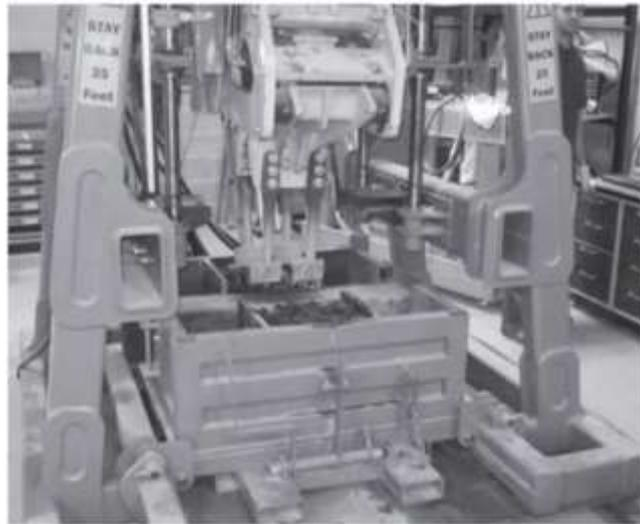
а - Лабораторные испытания подбивки (малый балластный ящик); рисунок воспроизведен из [72]
