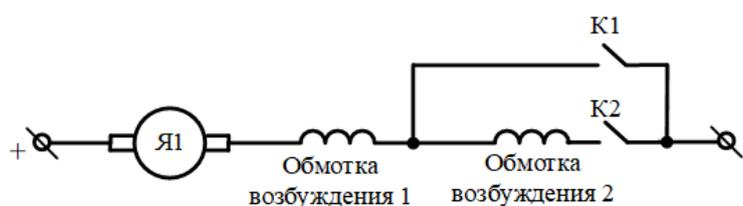
Рисунок 1.11 – Система ОВ ТЭД с отключением части витков обмотки возбуждения
