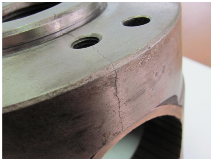
Рисунок 1.2.12 – Трещина на поршневой вставке дизеля 10Д100
