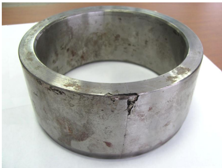
Рисунок 1.2.1 – Внешний дефект внутреннего кольца подшипника буксового узла, выявленный при помощи визуального контроля
