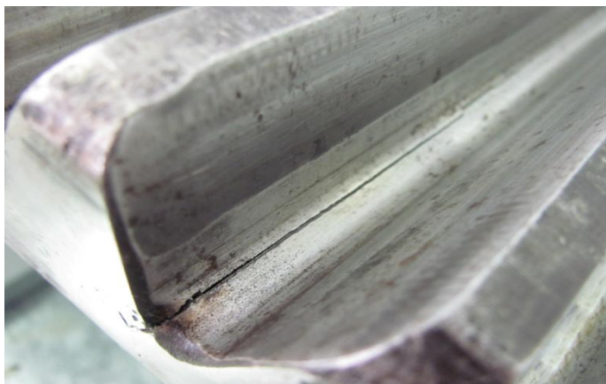
Рисунок 1.2.5 – Усталостная трещина на венце зуба шестерни тягового редуктора
