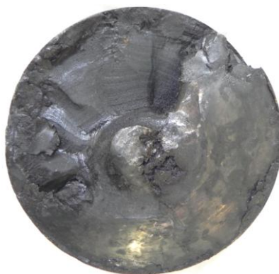
Рисунок 1.2.14 – Внутренний дефект в чистовой оси, выявленный ультразвуковым методом
