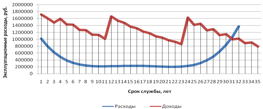
Рисунок 5.11 – Оптимальный срок службы полувагона (с КРП) при 20 %-м порожнем пробеге
