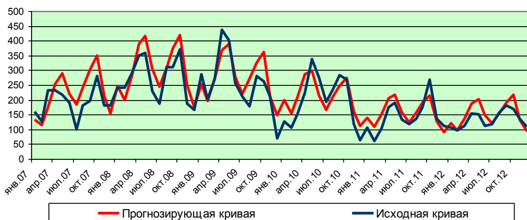
Рисунок 3.3 – Фактический динамический ряд по числу отцепок вагонов из-за нагрева буксового узла в сравнении с прогнозирующей кривой
