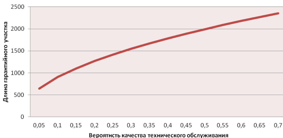
Рисунок 4.8 – Зависимость протяженности гарантийного участка безостановочного следования грузовых поездов от качества технического обслуживания
