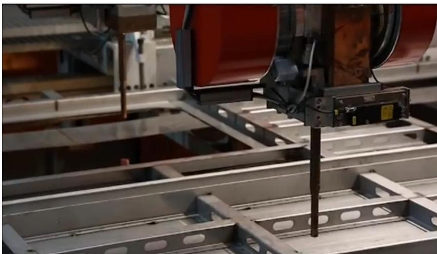
**Рисунок 1.19 – Фрагмент боковой стены двухэтажного пассажирского вагона в стенде сборки**
