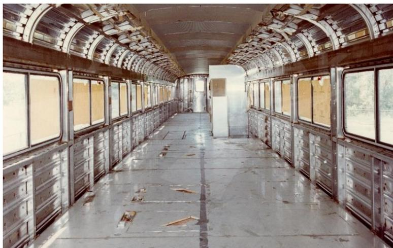
**Рисунок 1.3 – Несущая конструкция кузова вагона Superliner**
