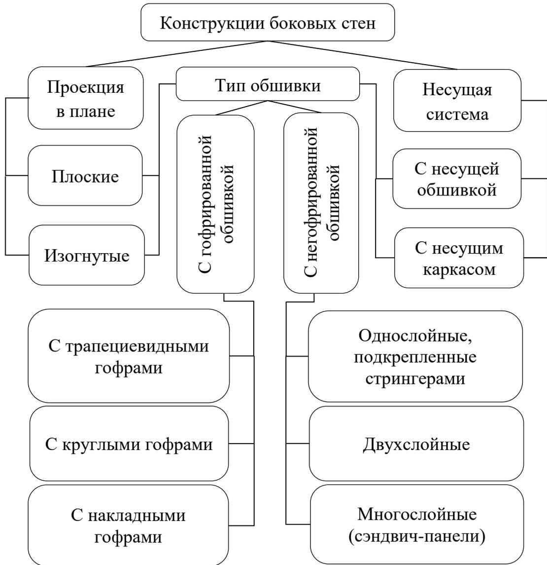
**Рисунок 1.1 – Классификация конструкций боковых стен пассажирских вагонов**
