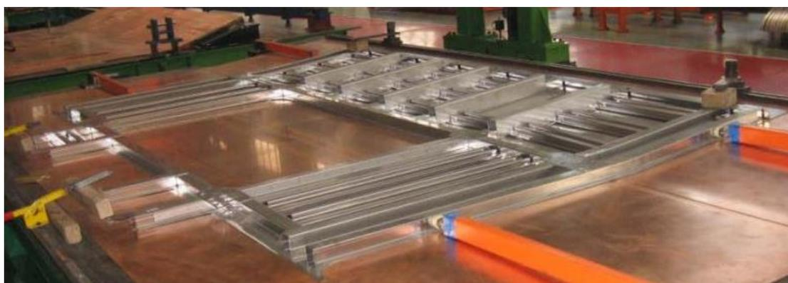
**Рисунок 1.4 – Панель боковой стены кузова вагона в стенде сварки**
