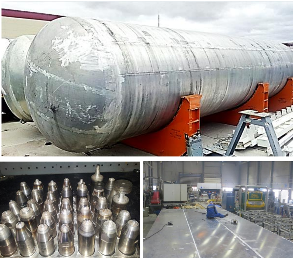
Рисунок 1.23 – Котёл вагона-цистерны, набор сварочного инструмента и этап сварки карты котла
