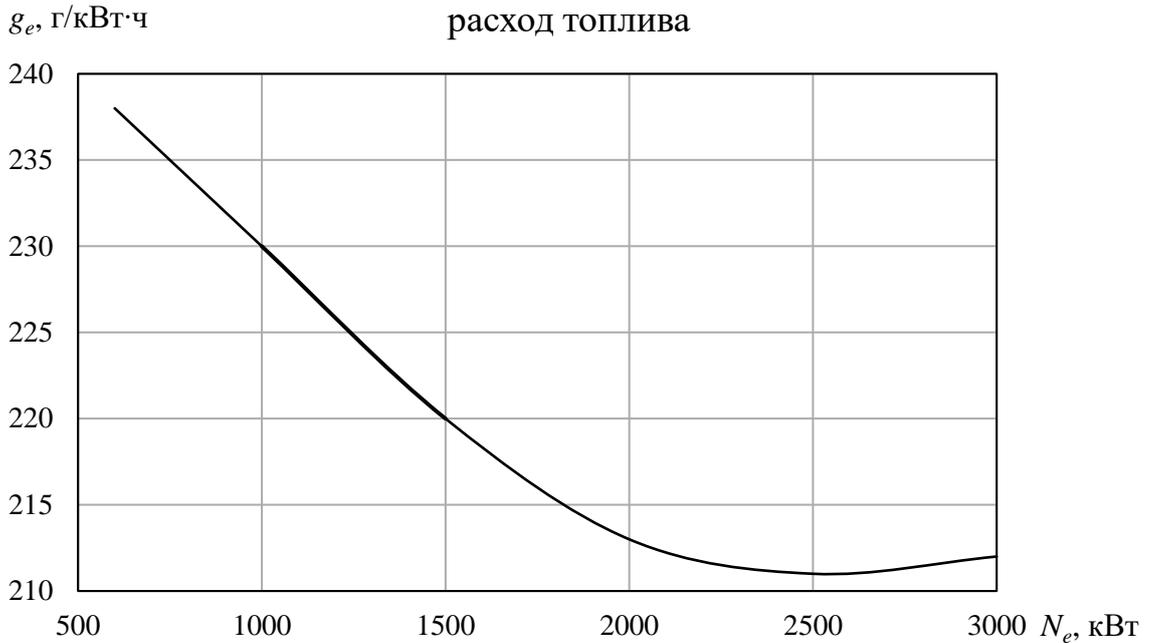
**Рисунок 4.15 – Параметры расхода топлива дизеля Д49 16ЧН 26/26
