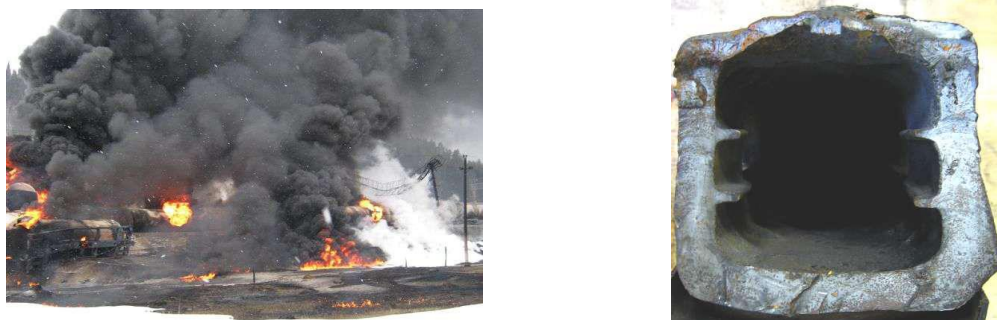
Рисунок 1 – Сход грузового поезда из-за излома боковой рамы
