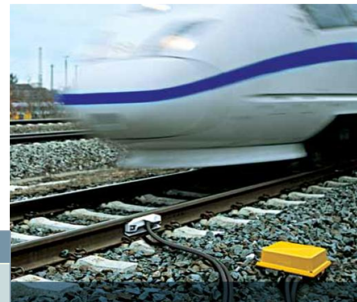
Принцип действия индуктивного колесного датчика ZP43
