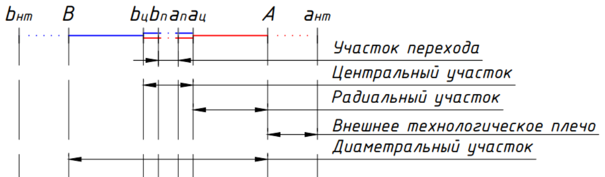
Рисунок 2.14 – Классификация участков на диаметральном направлении.
