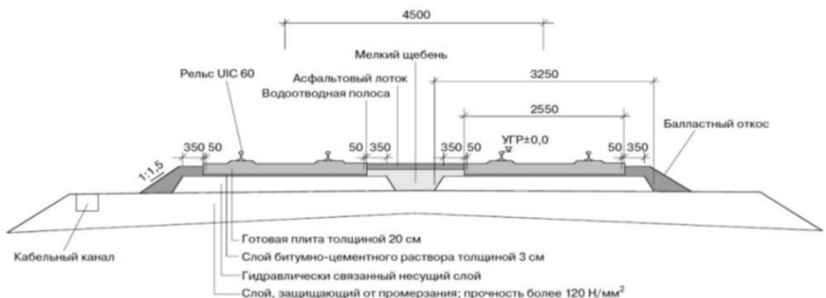
Рисунок 1.10 Безбалластный путь Bögl
