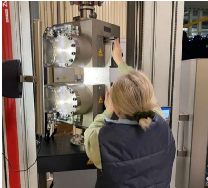
Рисунок 2.4 - Фиксация образца геосинтетического материала
